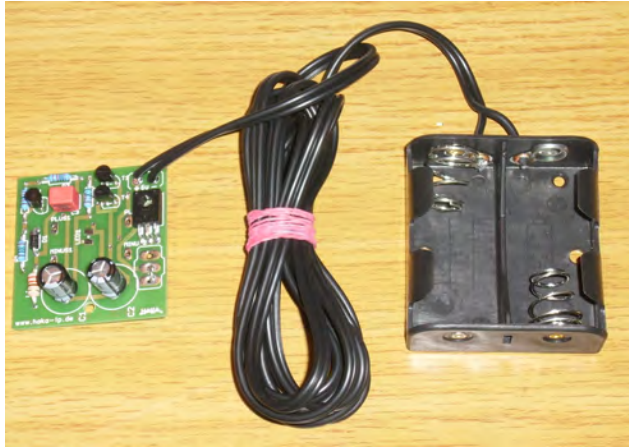
Bild 11: Verbindung zum Batteriepack
